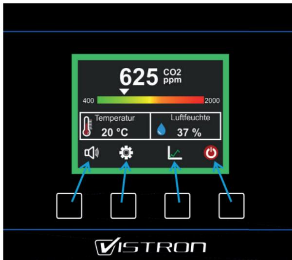
Die weißen Quadrate kennzeichnen die Touchpunkte zur Bedienung des CO<sub>2</sub> Monitors. Deren Anordnung entspricht der Anordnung der Symbole im Display. Um eine Funktion auszuführen berühren Sie immer den entsprechenden Touchpunkt - **nicht** das Symbol im Display.
